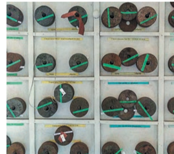
© Эти небольшие блоки, установленные внутри труб, помогают химикам узнать все о внутреннем состоянии теплотрасс
