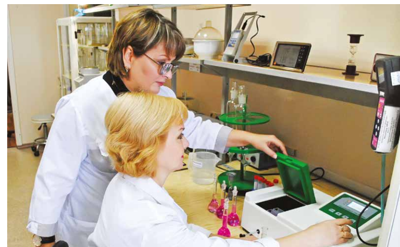
■ Инженеры ЦХЛ О. Сенча и Е. Овчаренко определяют количество нитратов в воде на спектрофотометре ПЭ 5300 ВИ
