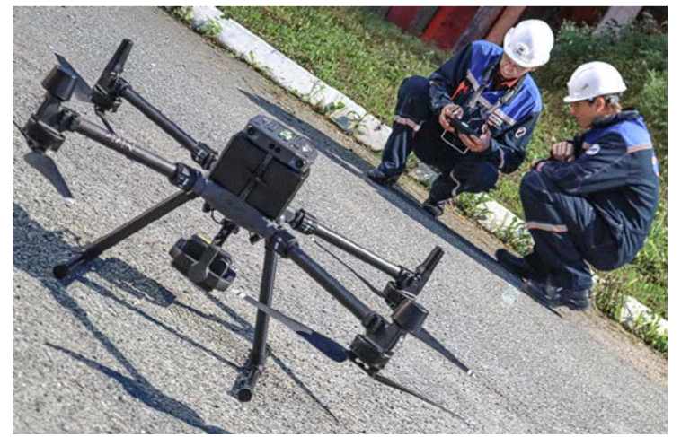
© Обследование дымовой трубы проходит рано утром, когда на результаты не влияет летняя жара. Фото: Екатерина Сенько
