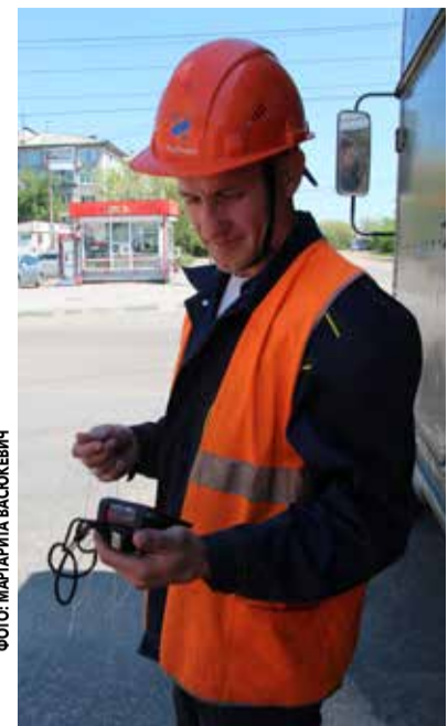
Перед спуском в тепловую камеру слесарь Алексей Кривцов проверяет достаточность кислорода газоанализатором
