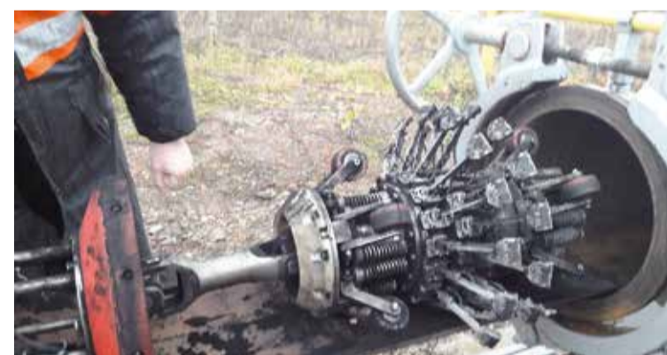
Снаряд-дефектоскоп готов к применению
