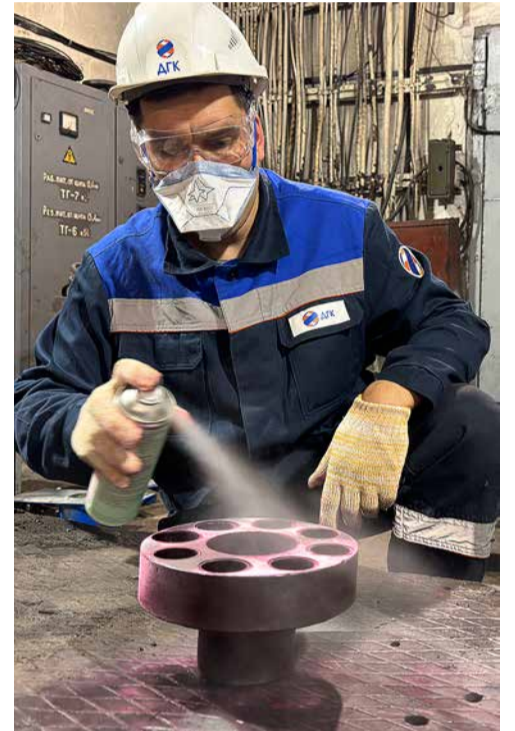
С помощью капиллярной дефектоскопии удается выявить невидимые трещины, непровары, поры, вкрапления инородных веществ. Фото: Александра Зуева
